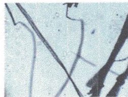
Figura 15 b: Fibras del floema de los tallos finos tratado con ácido seguido de tratamiento alcalino.
